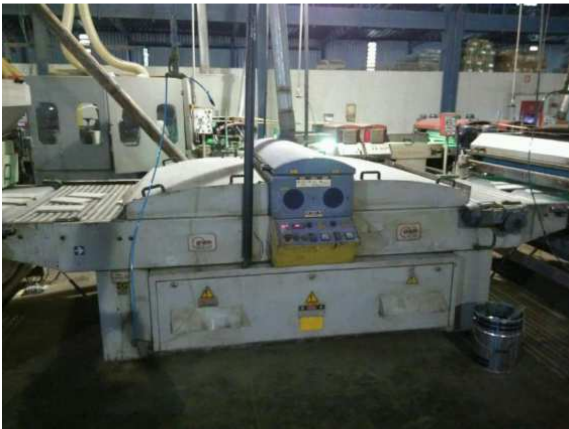
Fig. 227: Túnel UV 2 Lâmpadas
