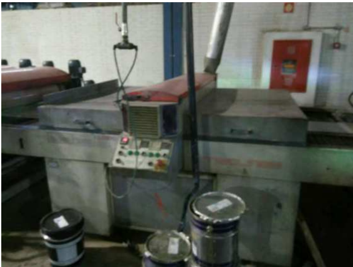
Fig. 223: Túnel UV 2 Lâmpadas
