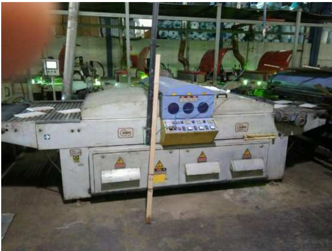
Fig. 237: Túnel UV 3 Lâmpadas
