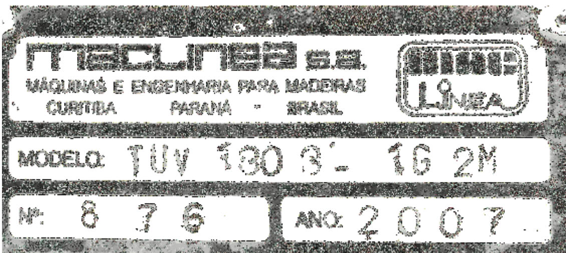
Fig. 246: Túnel UV 3 Lâmpadas (placa)
