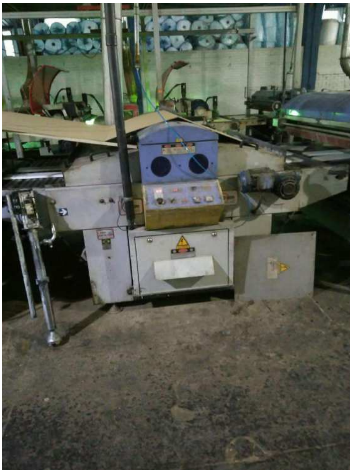
Fig. 215: Túnel UV 1 Lâmpada
