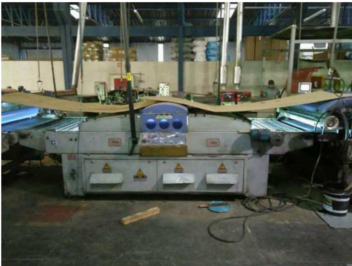
Fig. 243: Túnel UV 3 Lâmpadas
