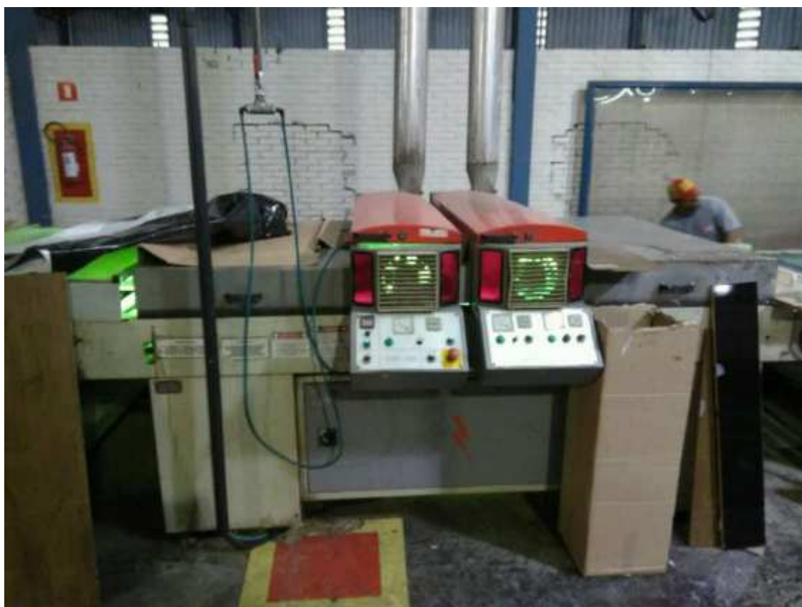
Fig. 239: Túnel UV 3 Lâmpadas
