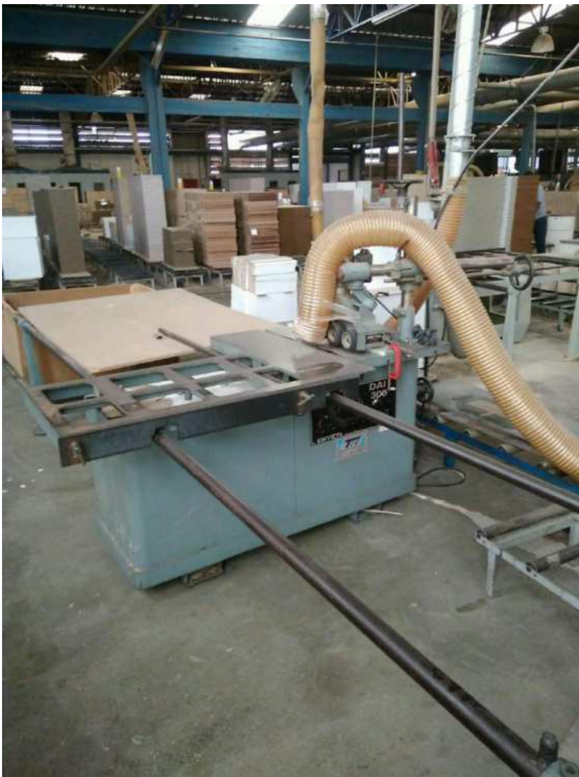
Fig. 111: Serra Esquadrejadeira, Riscador, eixo Inclínável e motor
