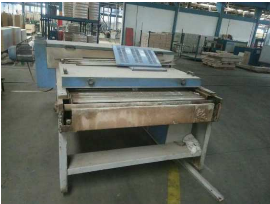
Fig. 249: Túnel UV 3 Lâmpadas
