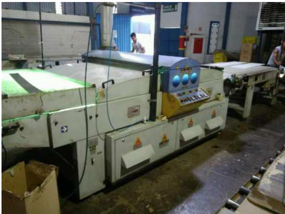
Fig. 235: Túnel UV 3 Lâmpadas
