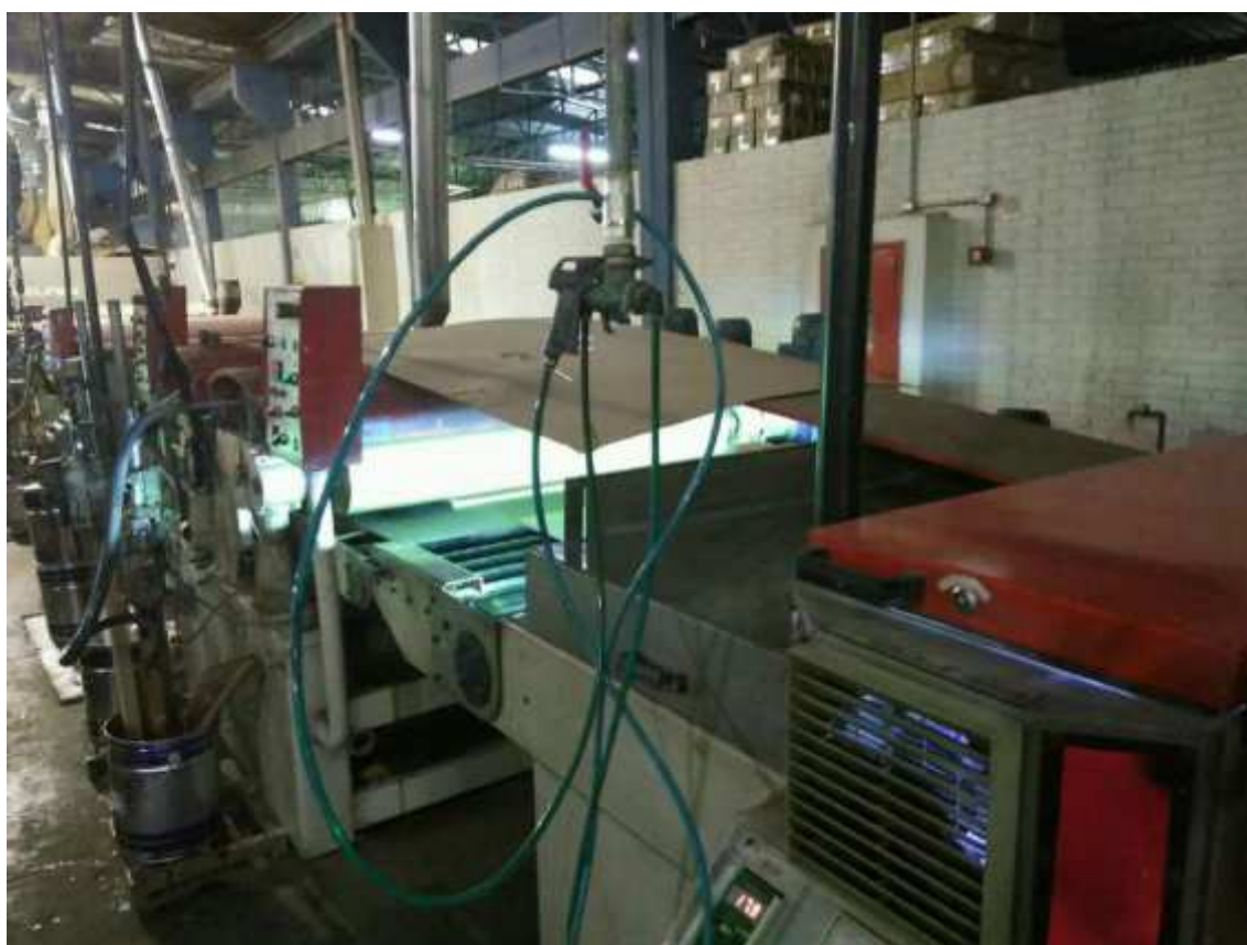
Fig. 233: Túnel UV 3 Lâmpadas
